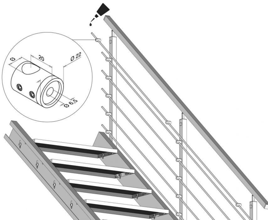
Befestigen Sie die Unterteile der Stabhalter an den Geländerpfosten. Stecken Sie die Oberteile der Stabhalter über die [Füllstäbe](#). Danach schrauben Sie die Stabhalter zusammen und richten die Füllstäbe aus. [Die Endstücke](#) der Füllstäbe werden mit Kappen verklebt.
