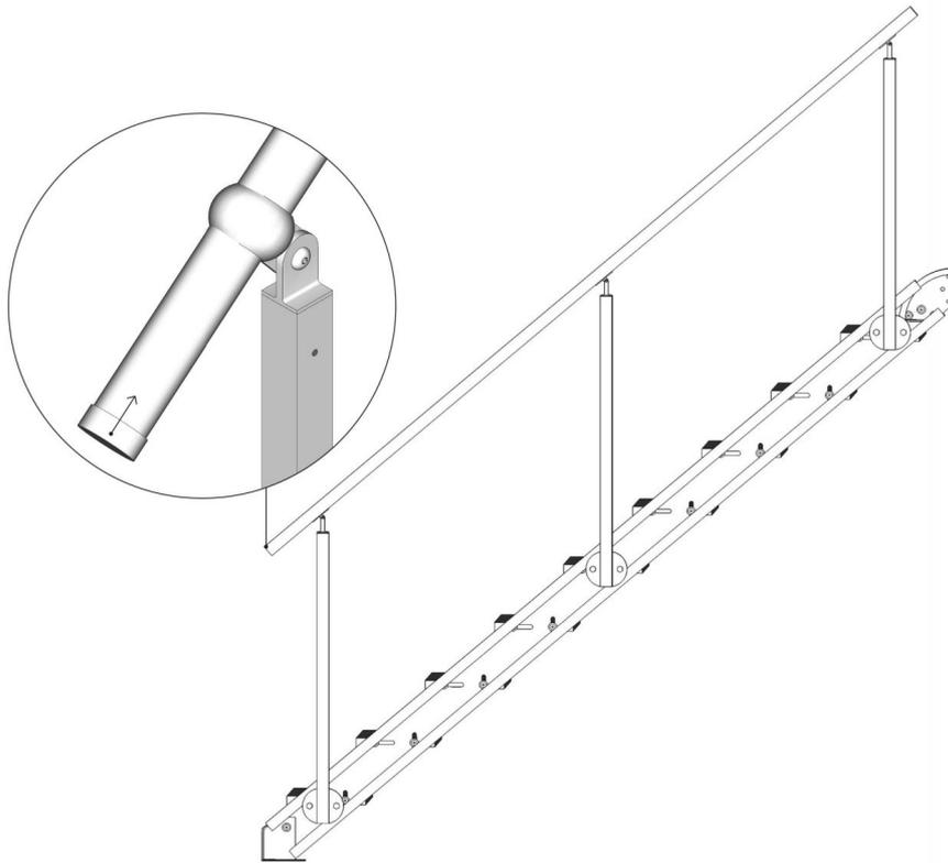
Schieben Sie die Handlaufshalter über den [verzinkten Handlauf](#). Danach befestigen Sie den Handlaufhalter an den Geländerpfosten. Schließen Sie den Handlauf mit [Endstopfen](#).
