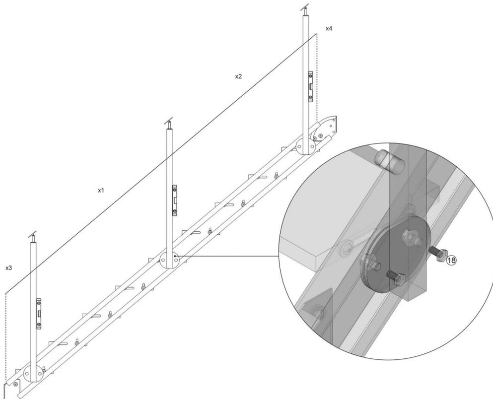
Platzieren Sie die [verzinkten Geländerpfosten/rostfreien Geländerpfosten](#) senkrecht und ziehen die Schrauben Nr. 18 fest (für verzinkten Pfosten verwenden Sie verzinkte Schraube Sechskant M10x45).
