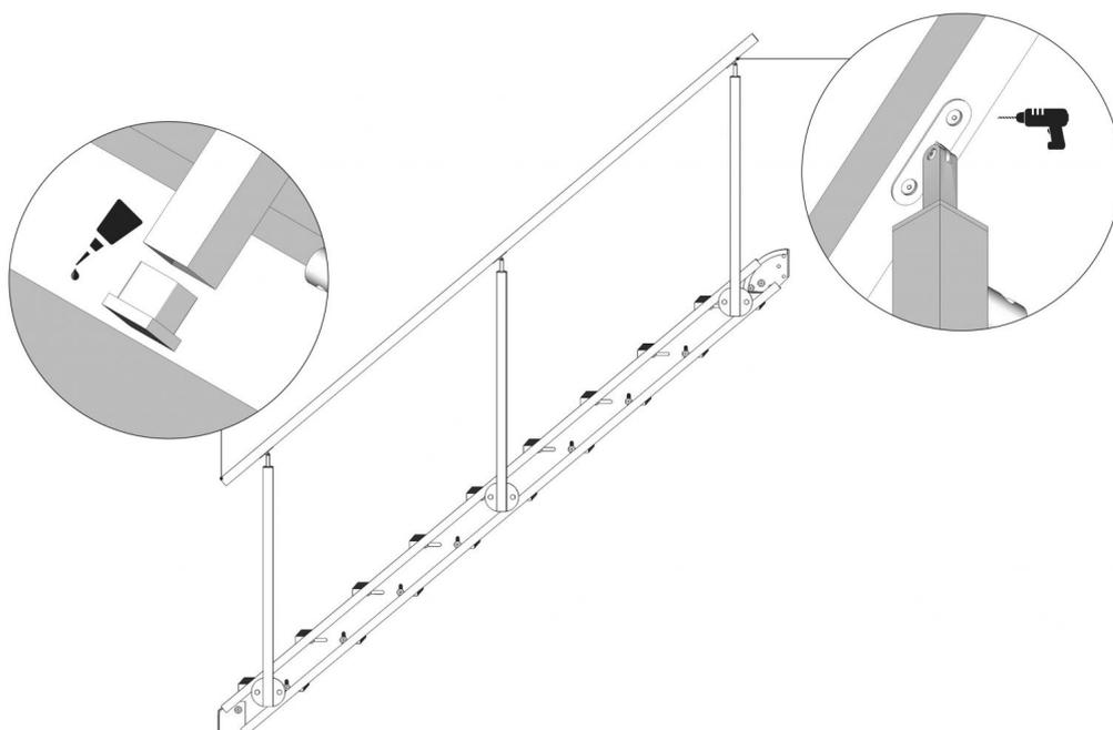
Befestigen Sie den [Edelstahlhandlauf](#) mit Edelstahlschrauben an den Geländerpfosten, danach schließen Sie den Handlauf mit [Endstopfen](#).
