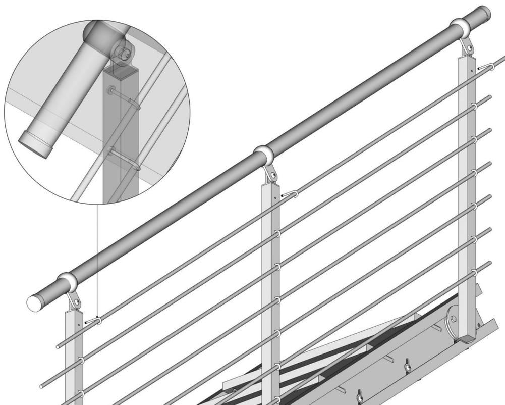
Befestigen Sie die [verzinkten Stäbe](#) durch Hackenschrauben an den Geländerpfosten. Justieren Sie die Stäbe und ziehen Sie diese fest. Nach Fertigung der Montage empfehlen wir alle verschraubten Verbindungen noch einmal zu kontrollieren und festzuziehen. Danach ist die sichere Begehung und Nutzung der Treppe gegeben.
